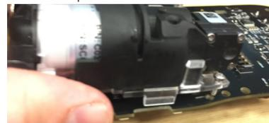
5. Levante el cierre situado en el conector ZIF del sensor 4R+ y extraiga el conjunto del cable del sensor 4R+ para desconectar de la PCB el conector de la bomba.
