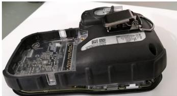
10. Vuelva a instalar los dos tornillos en la parte superior del instrumento (par 4-5 in-lbs).
