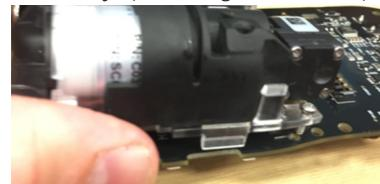
9. Inserte el cable de cinta del sensor 4R+ en el conector ZIF y presione hacia abajo el cierre situado en el conector ZIF del sensor 4R+ para enganchar el cable.
