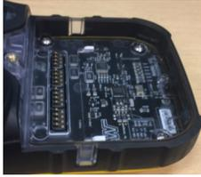
3. Retire los dos tornillos situados en la parte superior del instrumento y separe la carcasa trasera de la carcasa delantera.
