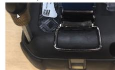
6. Para colocar el paquete de la batería correctamente, primero encaje los ganchos situados en la parte inferior del paquete de la batería.
