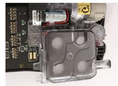
8. Empuje el colector hacia abajo para que los dos pestillos se enganchen, escuche los chasquidos de los pestillos y luego vuelva a instalar el tornillo en la esquina del colector.
