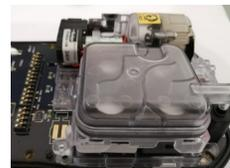
9. Vuelva a colocar la carcasa posterior e instale los cuatro tornillos nuevamente en el compartimiento de la batería (torque 4-5 in-lbs).
