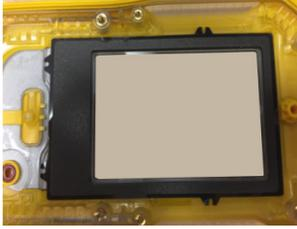
b) Presione el paquete de la batería en su sitio y apriete el tornillo de retención de la batería (par de apriete 0,452-0,565 N·m).
