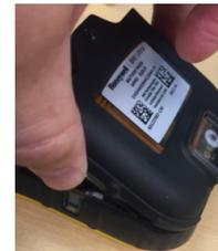
7. Presione el paquete de la batería en su sitio y apriete el tornillo de retención de la batería (par de apriete 0,452-0,565 N·m).
