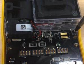
b) Vuelva a colocar la carcasa trasera e instale de nuevo los cuatro tornillos dentro del compartimento de la batería (par de apriete 0,452-0,565 N·m).
