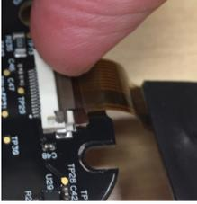
10. Vuelva a conectar el cable del sensor 4R+.
