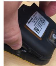
9. Presione el paquete de la batería en su sitio y apriete el tornillo de retención de la batería (par de apriete 0,452-0,565 N·m).
