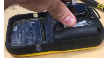
7. Vuelva a instalar los dos tornillos en la parte superior del instrumento (par de apriete 0,452-0,565 N·m).
