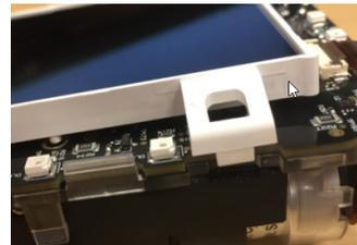
c) En la carcasa delantera, asegúrese de que la junta de la pantalla LCD quede alineada con las patillas. El marco debería estar orientado hacia arriba.
