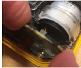
5. Vuelva a colocar la carcasa trasera e instale de nuevo los cuatro tornillos dentro del compartimento de la batería (par de apriete 0,452-0,565 N·m).
