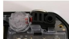
7. Inserte la entrada del colector en el colector de la bomba.
