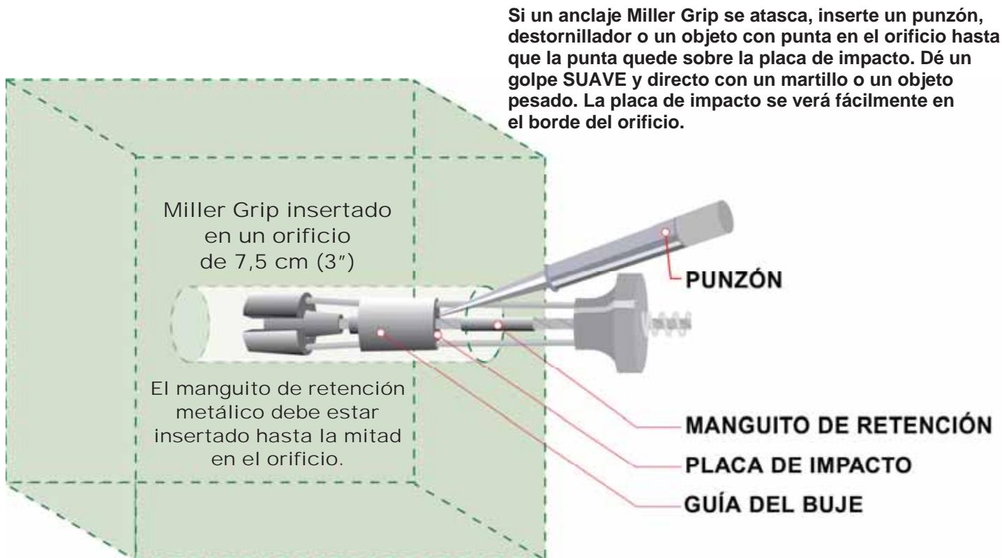
Los dispositivos de conexión utilizados junto con el conector de anclaje Miller Grip deben conectarse solo al bucle de anclaje.
