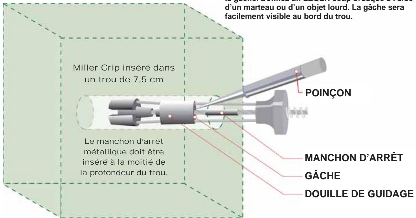
Les dispositifs de raccord utilisés avec le connecteur d'ancrage Miller Grip doivent être fixés à l'anneau d'ancrage seulement.
